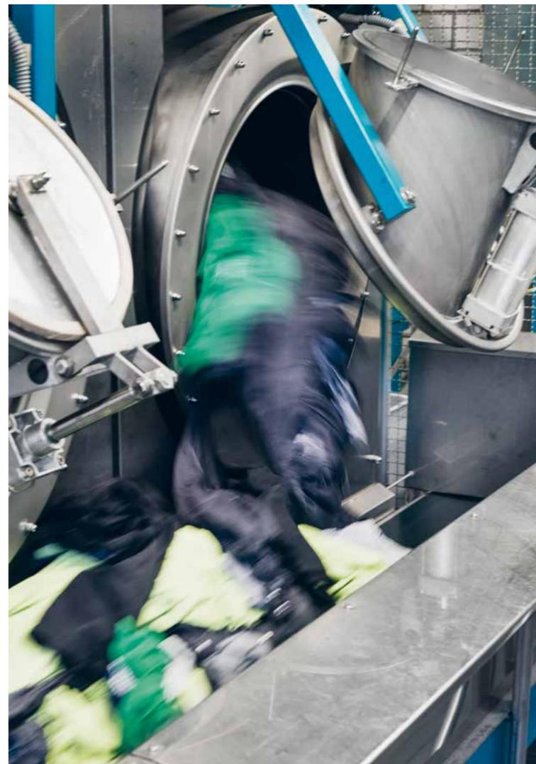
Automatisches Entladen der Waschmaschine und ...
